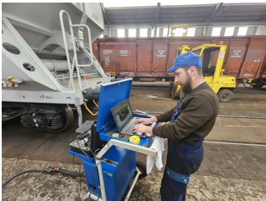
Vnos podatkov v digitalno testno napravo za testiranje zavor na tovornih vagonih tipa MI-8 Classic, proizvajalca Knorr-Bremse
